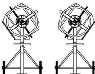
Не выключайте бетономешалку до тех пор, пока в барабане остается рабочая смесь. Выгрузка рабочей смеси из барабана должна осуществляться при его вращении.
