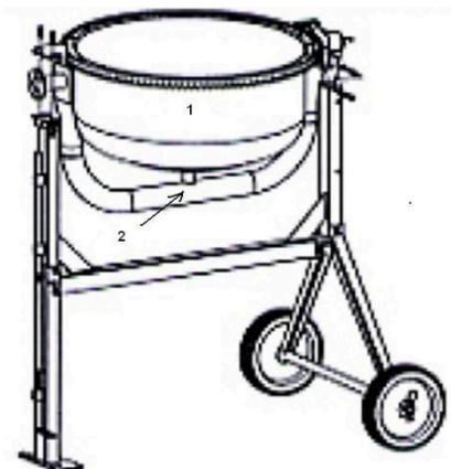
Установите нижний барабан (1) с осью крепления (2) на стойке основания барабана так, чтобы ось вошла в каналы стоек. Ось большого диаметра должна опираться на неподвижную опорную стойку. Зафиксируйте ось в стойках болтами М8 х 70.
