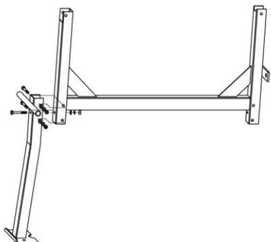
Совместите опорную стойку с рамой бетономешалки, чтобы совпали монтажные отверстия. Скрепите раму и опорную стойку болтами М8 х 70, таким же образом закрепите стойку с колесами.
