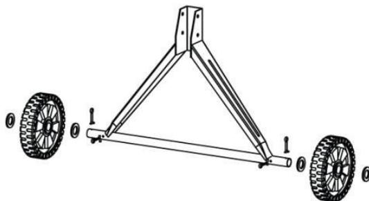
Вставьте шплинт во внутренние отверстия в каждой оси, наденьте плоскую шайбу, затем колесо, сопровождаемое другой плоской шайбой. Вставьте другой шплинт в отверстия оси вне каждой плоской шайбы. Согните каждую сторону шплинта, направленных наружу, таким образом, чтобы они не выпали.
