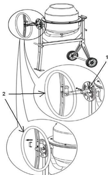
Установите фиксирующий диск (1) на ось вращения барабана и закрепите винтами М10 х 20. Зафиксируйте пружину стопорного механизма в Ш-образной пластине и надвиньте поворотное колесо (2) на ось барабана до совмещения с отверстием фиксации поворотного колеса. Зафиксируйте поворотное колесо болтом. Снимите Ш-образную пластину с пружины.
