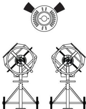
Барабан зафиксирован в одном положении при помощи хомута на штекерном колесе. Для наклона барабана выдерните штекерное колесо, чтобы расцепить замыкающий зажим. Это позволит повернуть штекерное колесо и барабан в одном направлении. Чтобы удерживать барабан в таком положении, регулируя выемки с зажимами, освободите штекерное колесо, немного придерживая барабан. Вращайте штекерное колесо до тех пор, пока соединяющий зажим не попадет в соединяющую пластину на корпусе бетономешалки.
