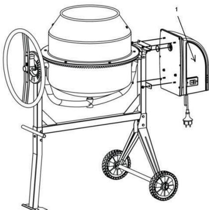
Выставив в одну линию шлицевой паз, надвиньте корпус редуктора (1) на вал-шестерню. Прикрепите корпус редуктора к каркасу двумя болтами 4,8 х16. Зафиксируйте болты плоской шайбой, стопорной шайбой и гайкой.
