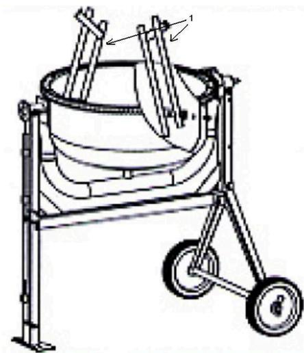
Вставьте болты М8 х 20 с внешней стороны нижнего барабана, затем установите на болты кожаные шайбы. После этого установите смешивающие ножи (1), вставив плоскую шайбу и стопорную шайбу, зажмите гайкой.
